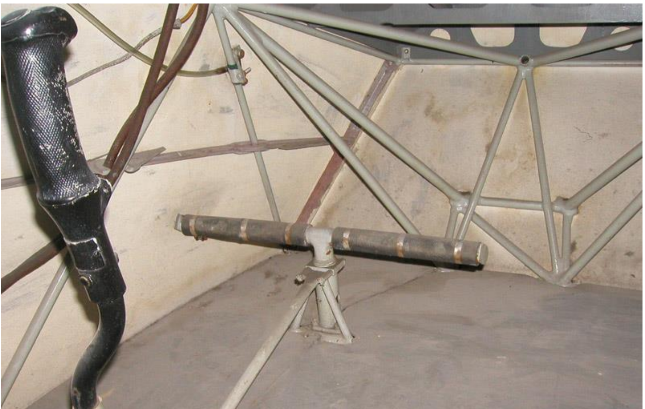
Śmigłowiec SP-GIL – stan zachowania układu sterowania oraz wewnętrznej strony poszycia kadłuba
