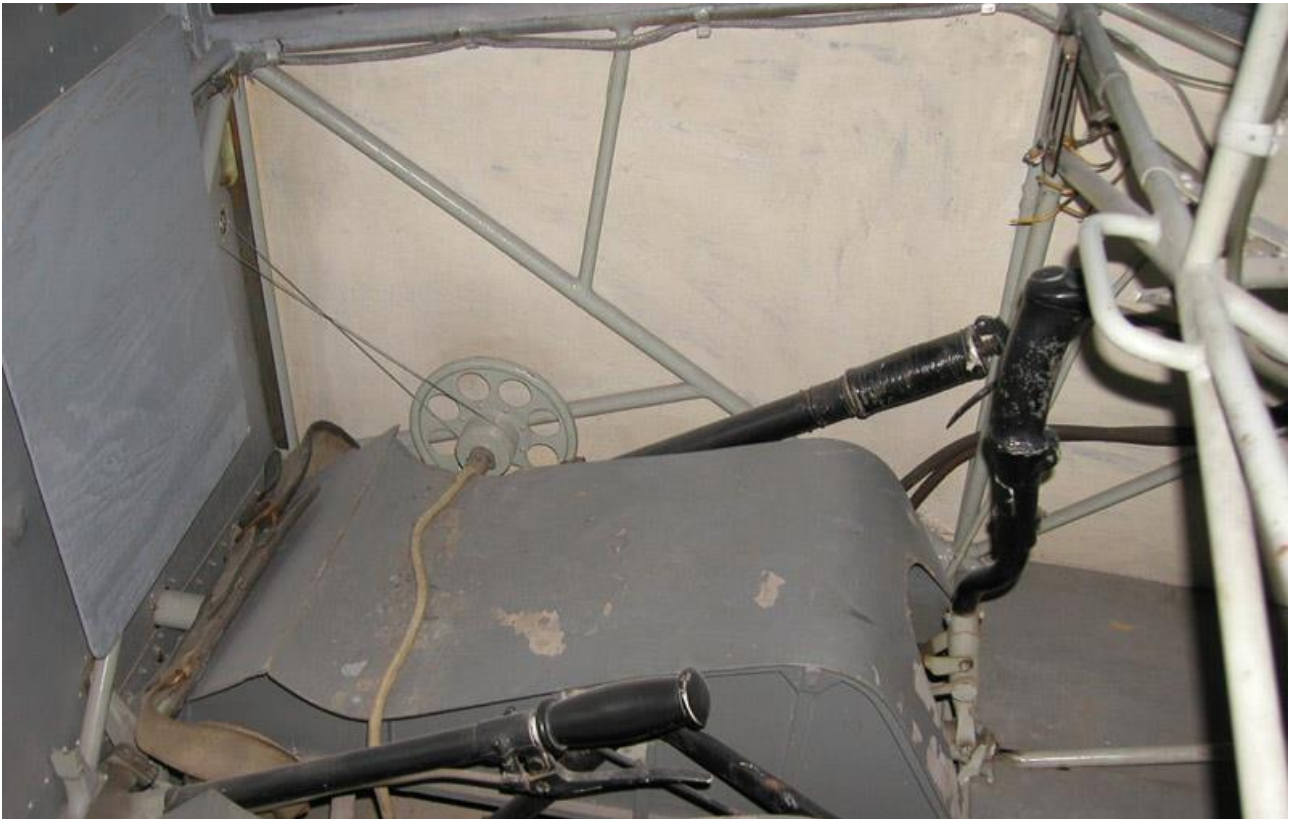
Śmigłowiec SP-GIL – stan zachowania fotela pilota oraz wewnętrznej strony poszycia kadłuba
