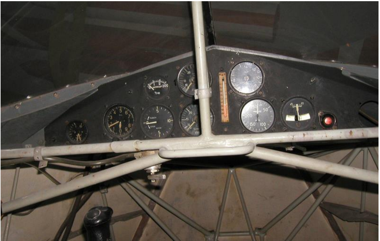
Śmigłowiec SP-GIL – stan zachowania panelu kontrolnego oraz kratownicy kadłuba
