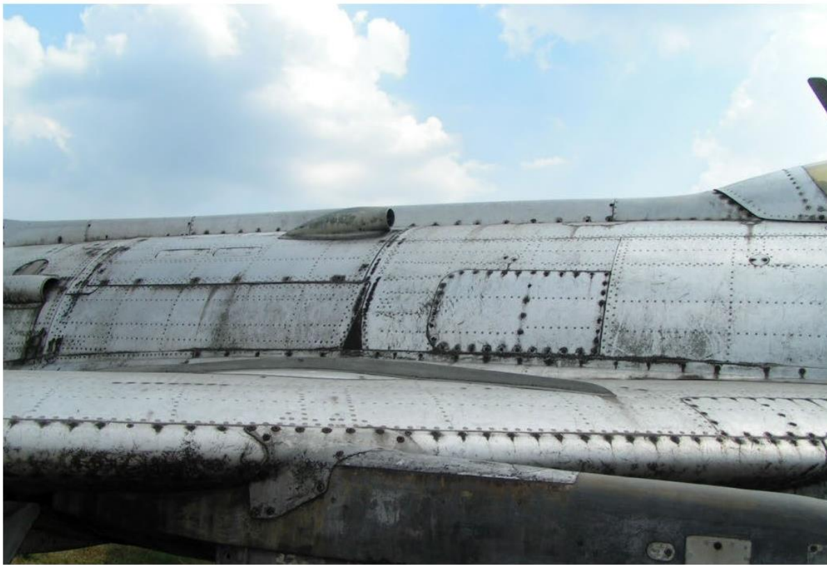
Samolot typu MiG-19PM – stan łączenia kadłuba z płatem. Szczególnie widoczne utlenienie powierzchni kadłuba
