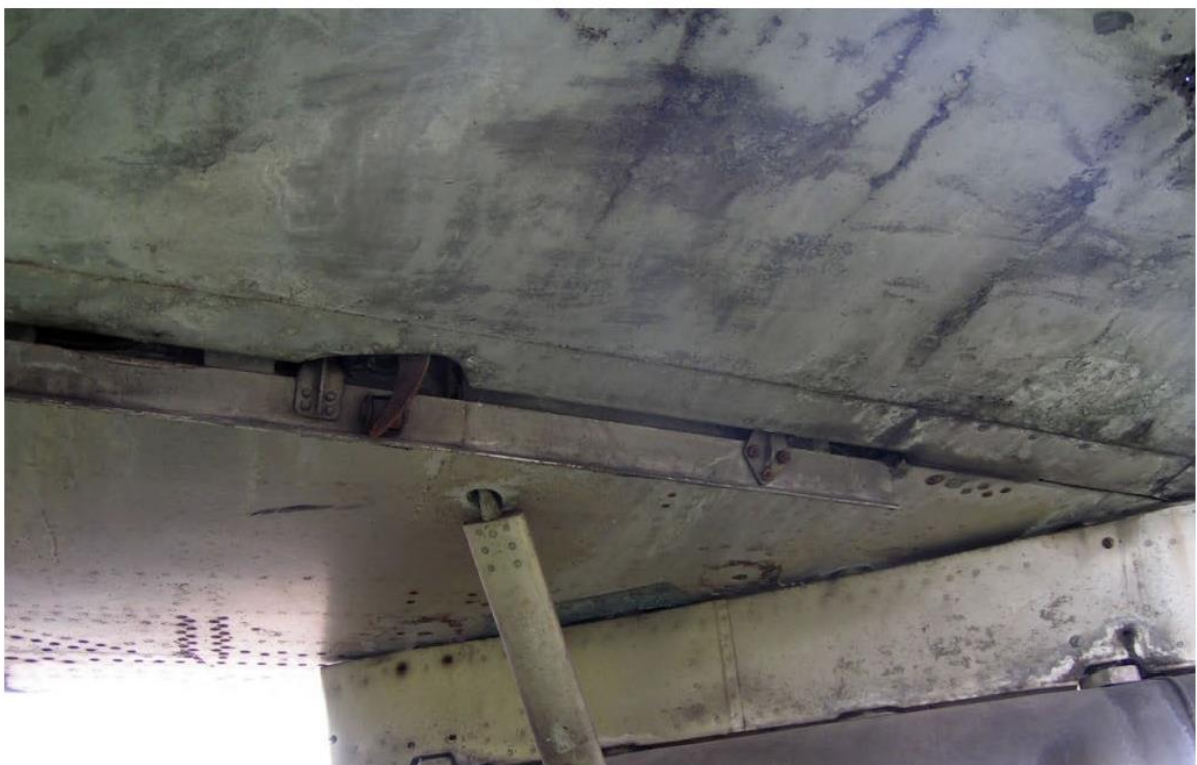
Samolot typu MiG-19PM – stan zachowania dolnej płata - utlenienie powierzchni
