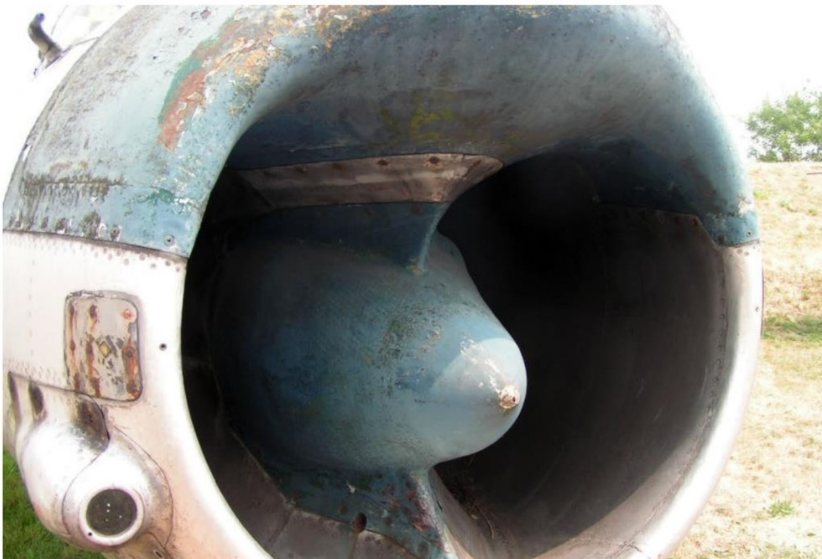
Samolot typu MiG-19PM – stan zachowania osłon radarów
