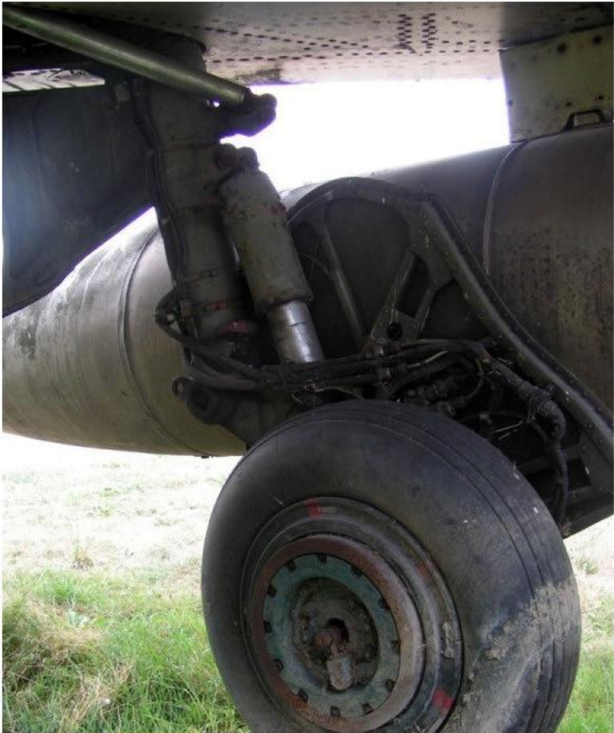
Samolot typu MiG-19PM – stan zachowania podwozia głównego
