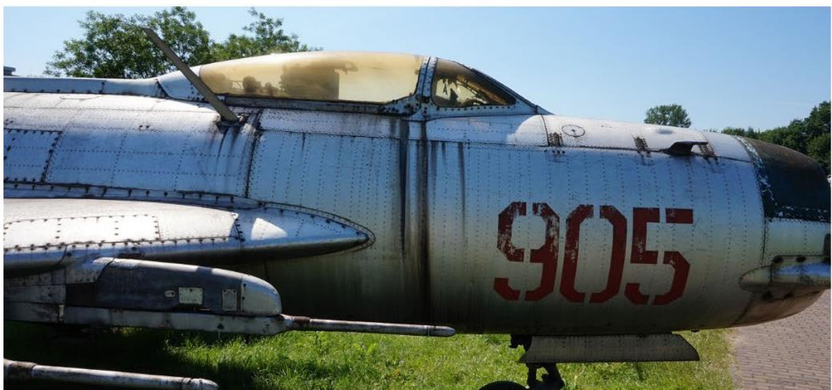
Samolot typu MiG-19PM – ogólny stan zachowania części przedniej kadłuba
