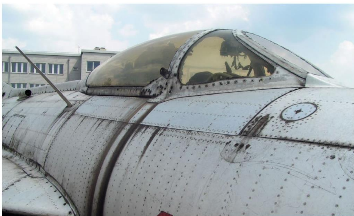
Samolot typu MiG-19PM – stan zachowania osłony kabiny. Szczególnie widoczne utlenienie powierzchni
