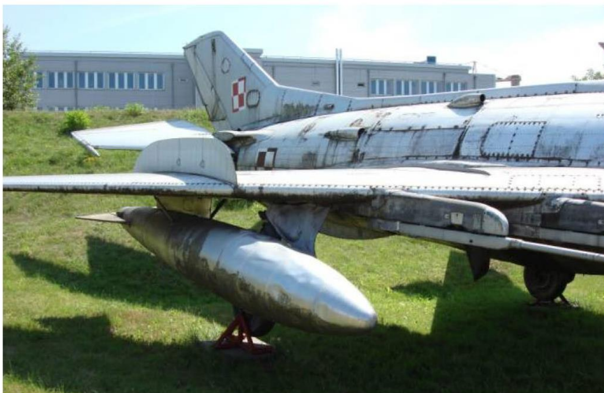
Samolot typu MiG-19PM – stan zachowania tylnej części kadłuba i zbiorników
