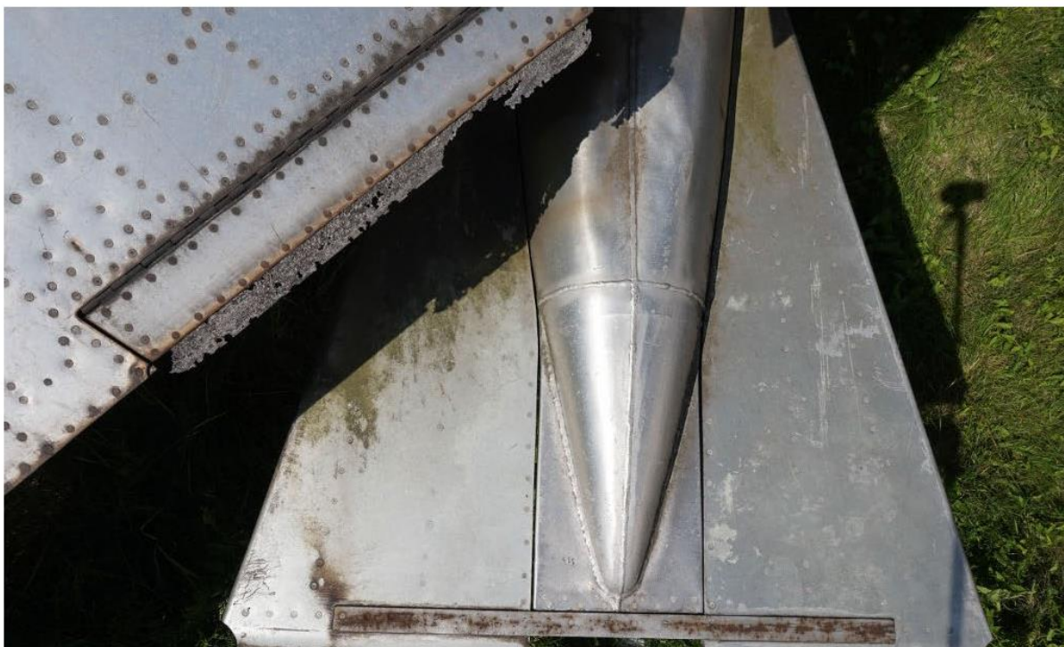
Samolot typu MiG-19PM – ogólny stan zachowania płatów – widoczna korozja wżerowa
