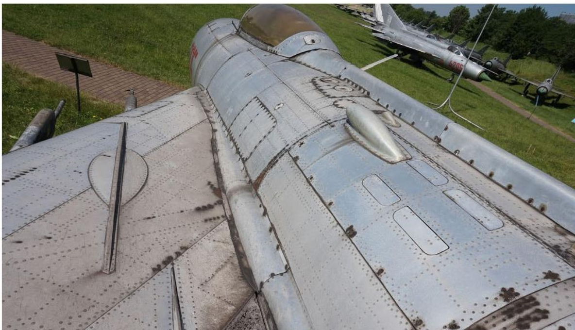
Samolot typu MiG-19PM – ogólny stan zachowania górnej części kadłuba
