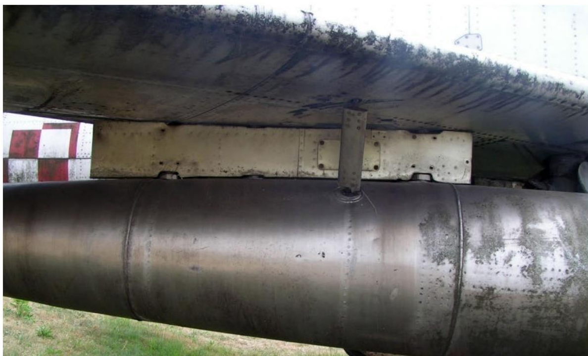
Samolot typu MiG-19PM – stan utlenienia powierzchni kadłuba
