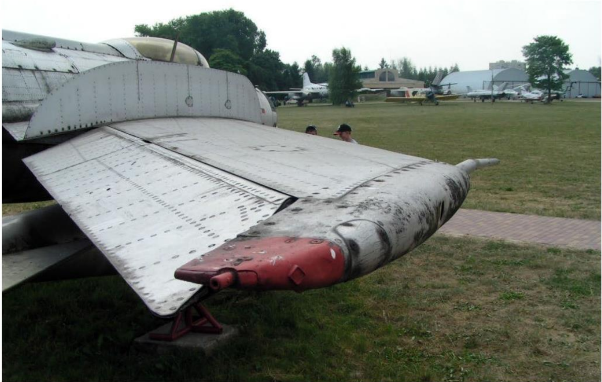
Samolot typu MiG-19PM – stan zachowania końcówki płata - utlenienie powierzchni
